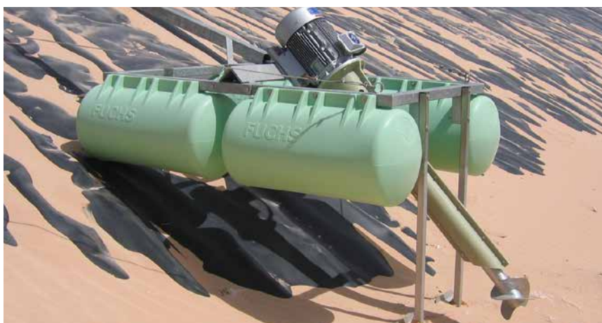
Aerador OxyStar® em flutuadores
