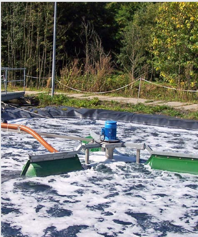
Inyector de gas Centrox CX-G sobre flotadores
