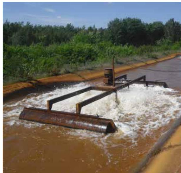
Aérateurs AeroStar sur flotteurs pour l'extraction (stripping) du gaz carbonique
