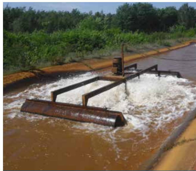
Aireadores AeroStar sobre flotadores para la extracción de dióxido de carbono (Alemania)
