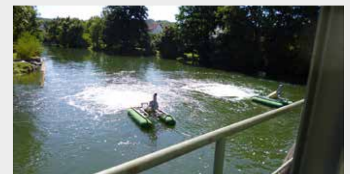
Aireadores FUCHS en una aplicación de emergencia en un río (Alemania)
