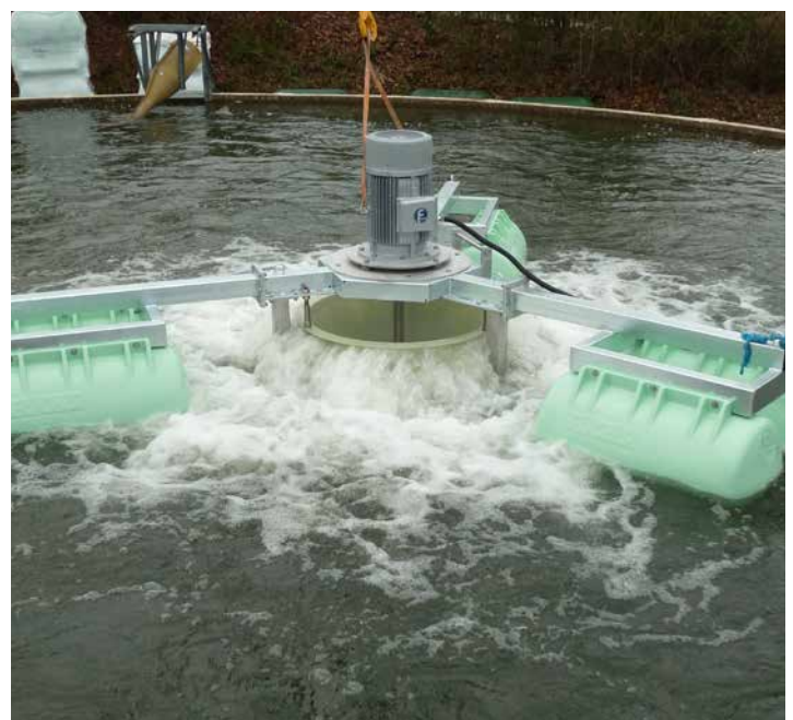
Contrôle du fonctionnement dans le bassin d'essai FUCHS
